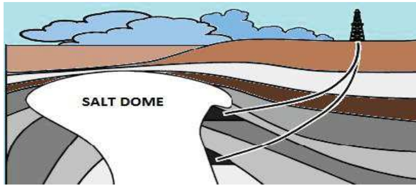
Fig. I.7 Image représente un Forage de dôme de sel (Salt Dome Drilling). [5]
