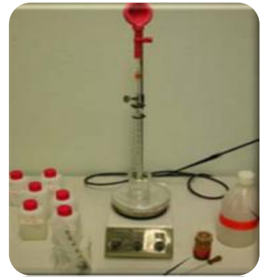
matériel de mesure par titrimétrie
