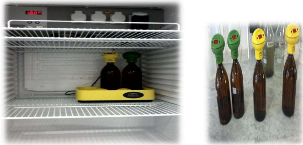
Fig. N°(09) : Matériel utilisé pour déterminer la valeur de DBO_5
