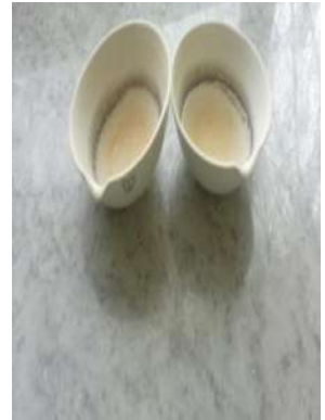
Fig. N° (07) : Matériel utilisé pour détermine la valeur de MES
