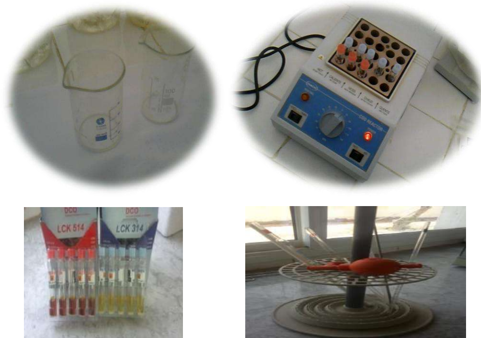
Fig. N°(08) : Matériel utilisé pour détermine la valeur de DCO
