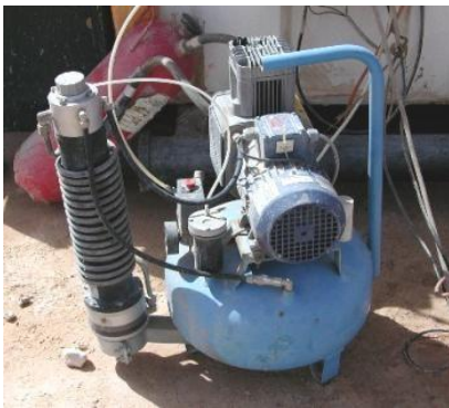
Figure 27 : Compresseur à air
