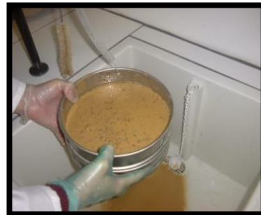
Figure 17 : lavage et tamisage d'échantillon
