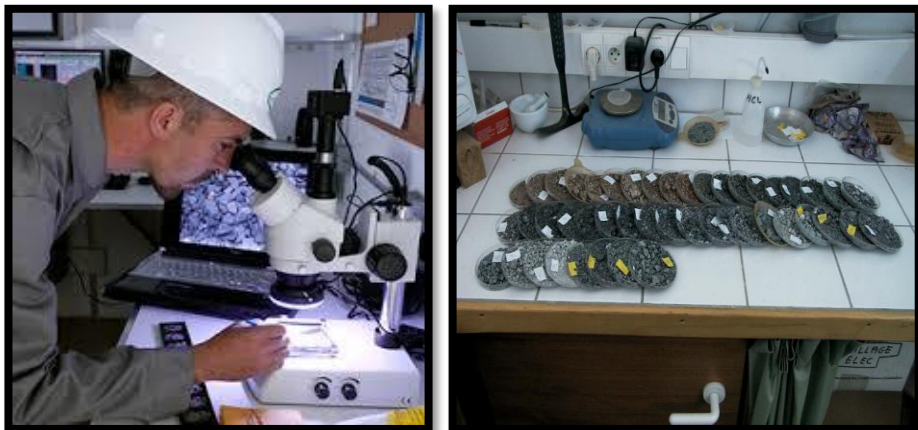
Figure 19 : L'analyse des échantillons sur le Microscope Binoculaire
