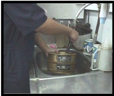
Figure 17 : lavage et tamisage d'échantillon
