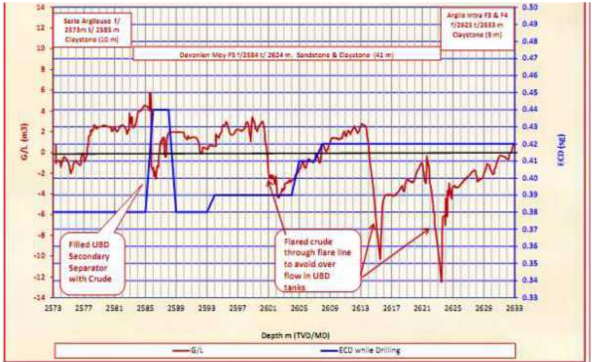
Figure IV.9 : Gestion de gain/perte et l'ECD pendant le forage.[17]
