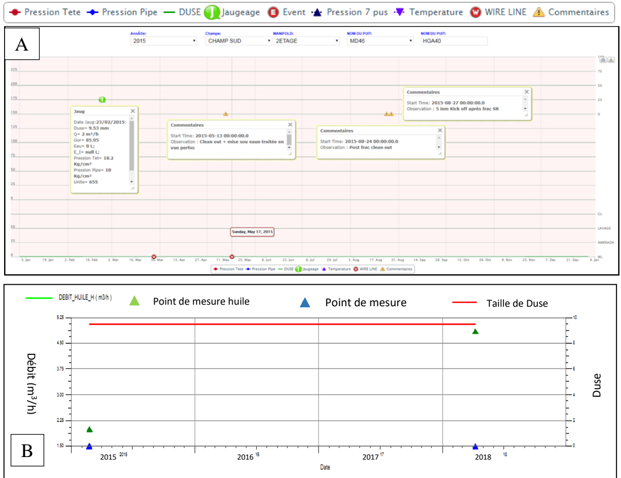
Figure n°44 : Etat du puits HGA40 : A. Cahier de courbe. B. historique de Production (SH/DP-Data Bank, OFM, 2018)
