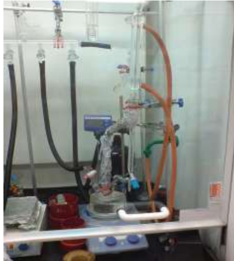
Fig. 37 : appaerille de Dean Stark (Document Sonatrach « CRD »2014)
