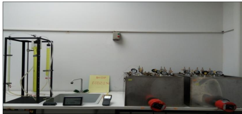
Fig. (14) : Image indiquant l'équipement de mesure de la désorption de gaz après installation
