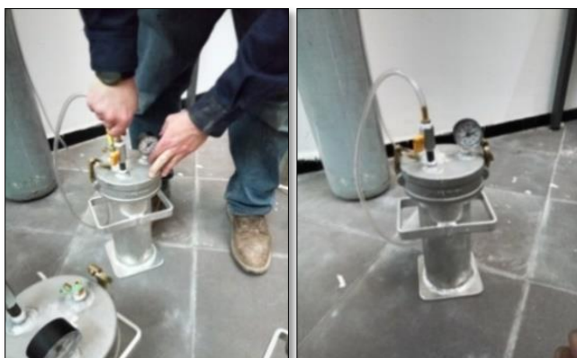
Fig. (10) : Images d'injection des canisters par l'air comprimé
