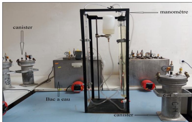
Fig. (8) : Image représente les composants de système de désorption de gaz
