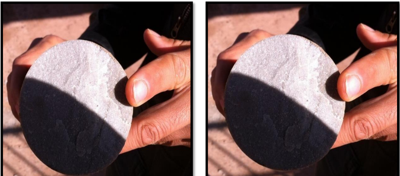
Photos.02 : Cassures sur carotte du puits HRC063 montrant Grès Fortement Quartzitique (Benamor, O. 2017)
