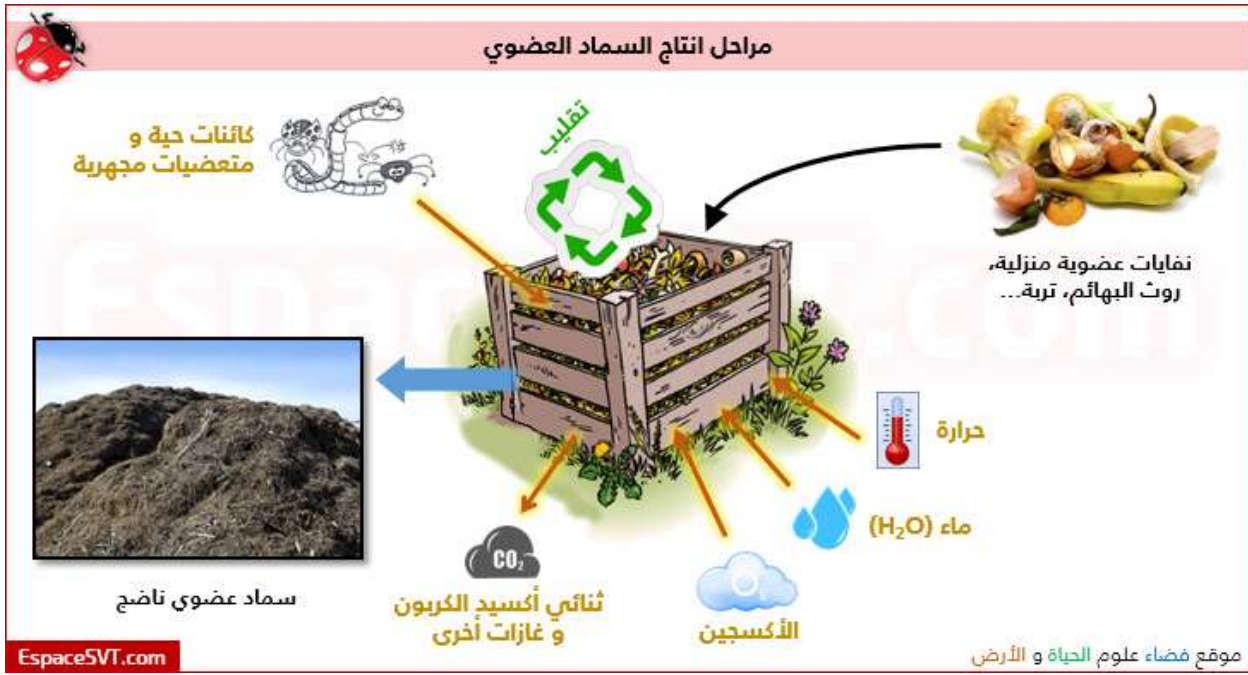
الشكل 4- 5: رسم توضيحي تفسيري لمراحل إنتاج السماد العضوي.
