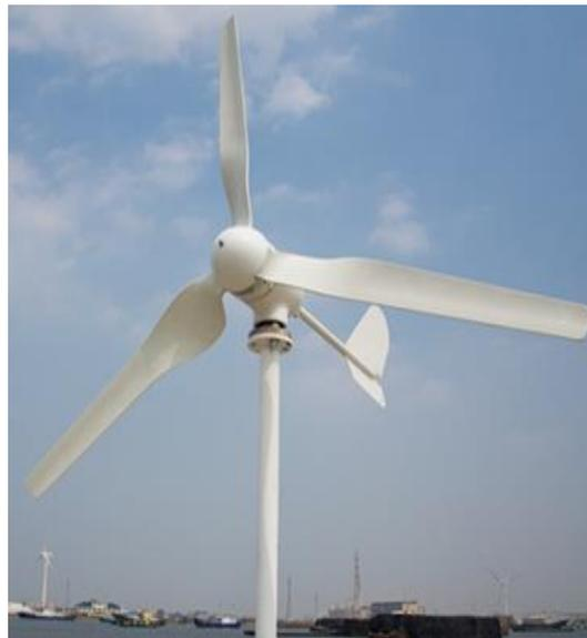
**Figure II -5 :** éolienne a axe horizontale
