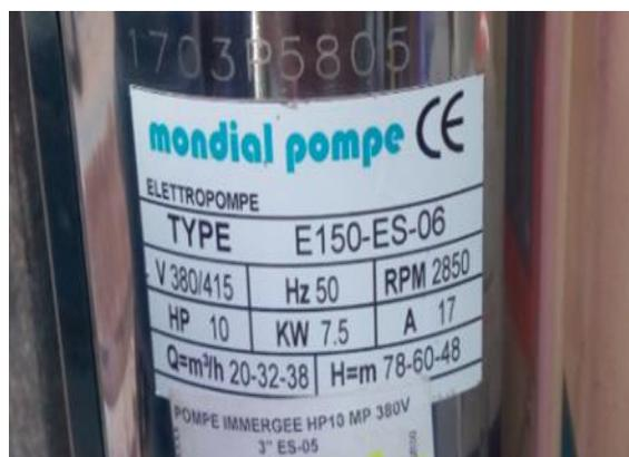
**Figure III-4 :** Caractéristiques du pompe
