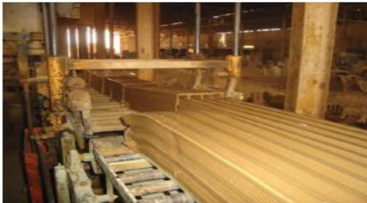
Figure II-2 Coupage de brique moulé
