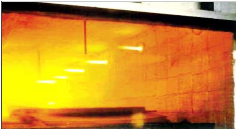
Figure II- 8: Brûleurs à haute vitesse dans un four tunnel
