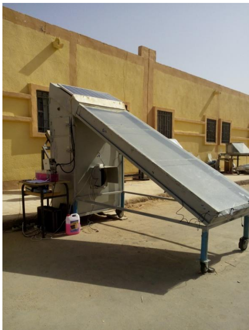
Séchoir solaire indirect actif ou forcé
