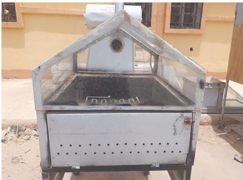
Séchoir solaire direct avec l'appoint énergétique (échangeur)
