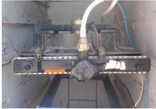
Figure (II.8) : Échangeur de chaleur intérieur de la chambre de séchage
