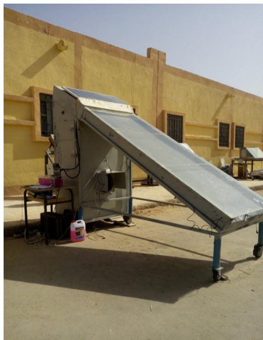
Figure (II.7) : Le montage du système de l'échangeur de chaleur
