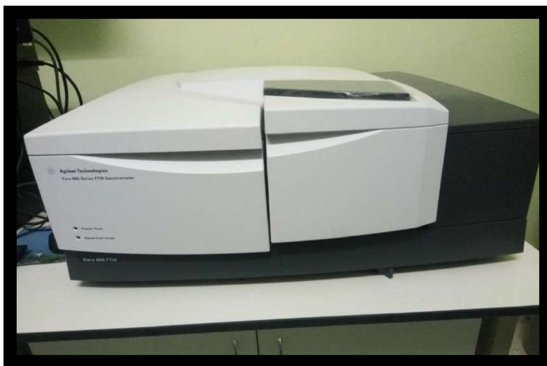
Fig.10 : Spectromètre infrarouge (IRFT-ATR)
