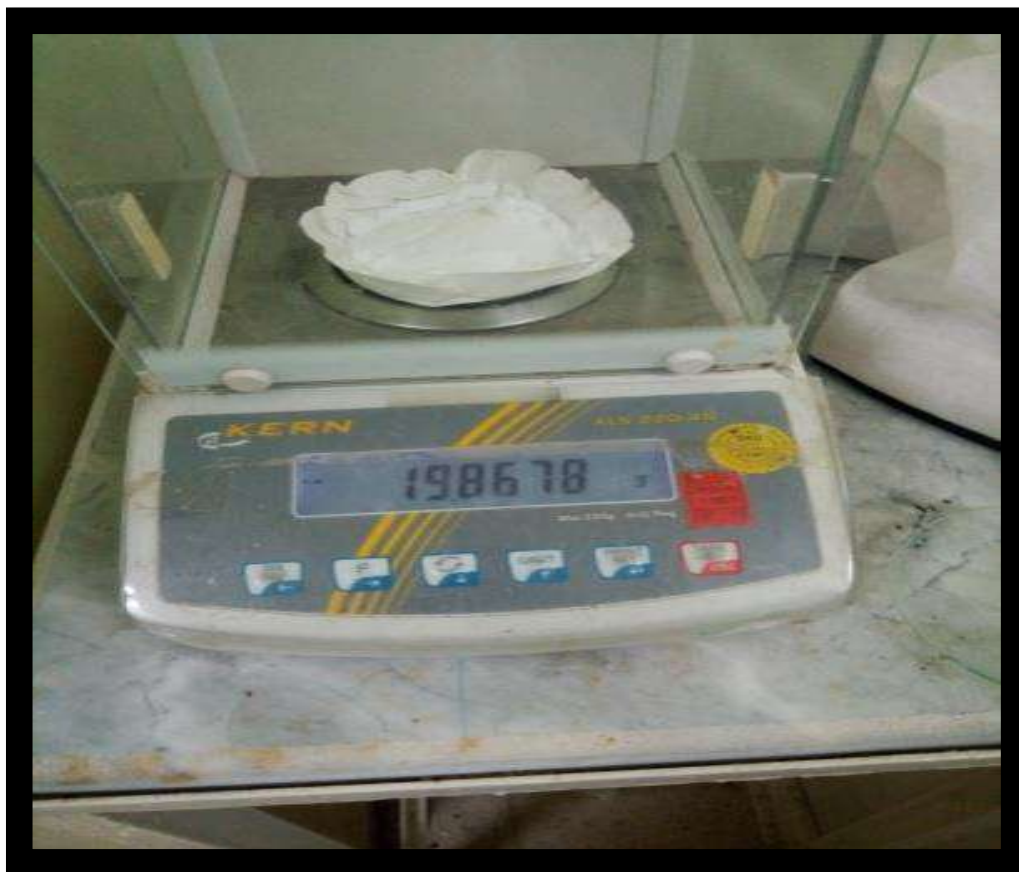
Fig.9 : Pesage du produit obtenu \text{NH}_4\text{Cl}
