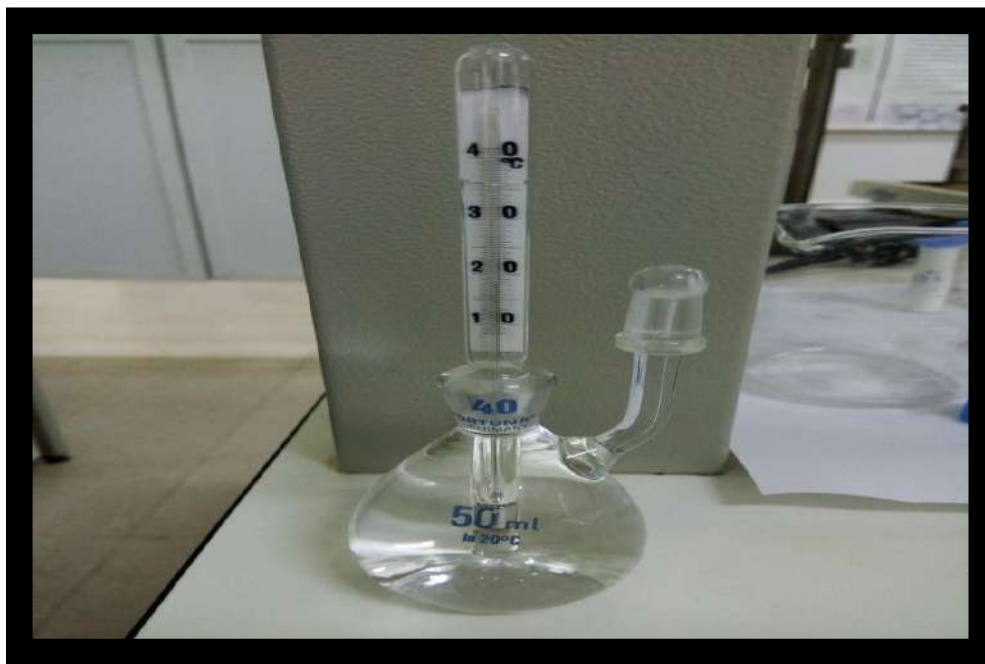
Fig.13 : Densité par Méthode de Pycnomètre
