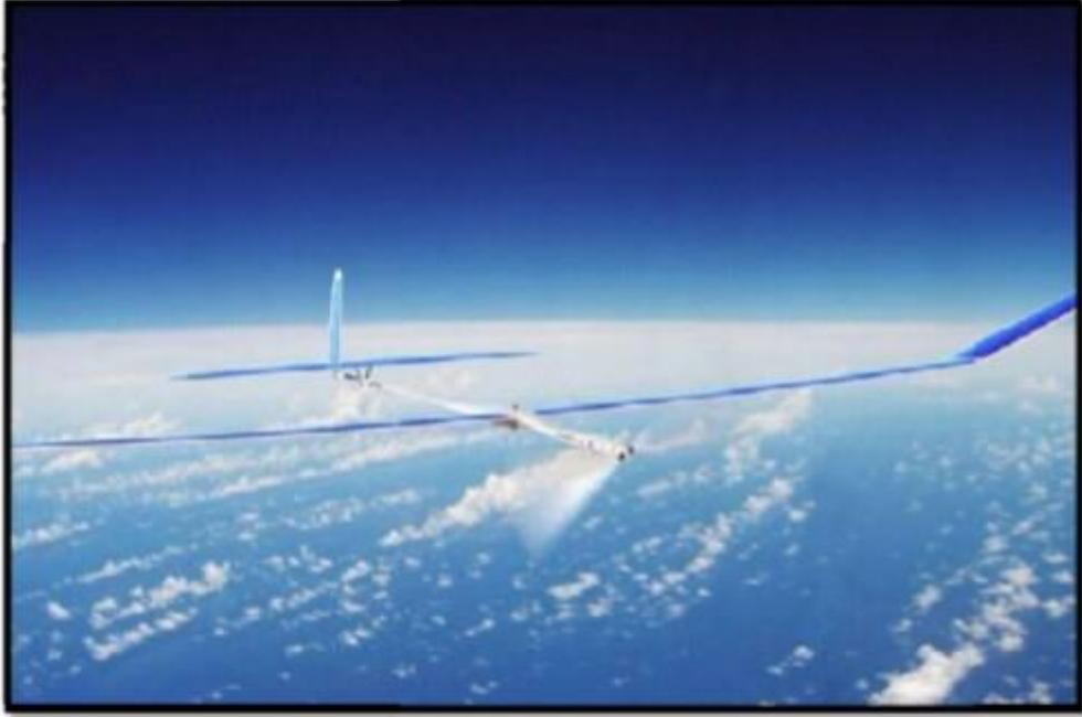
( طائرة بلا طيار تعمل بالطاقة الشمسية )
