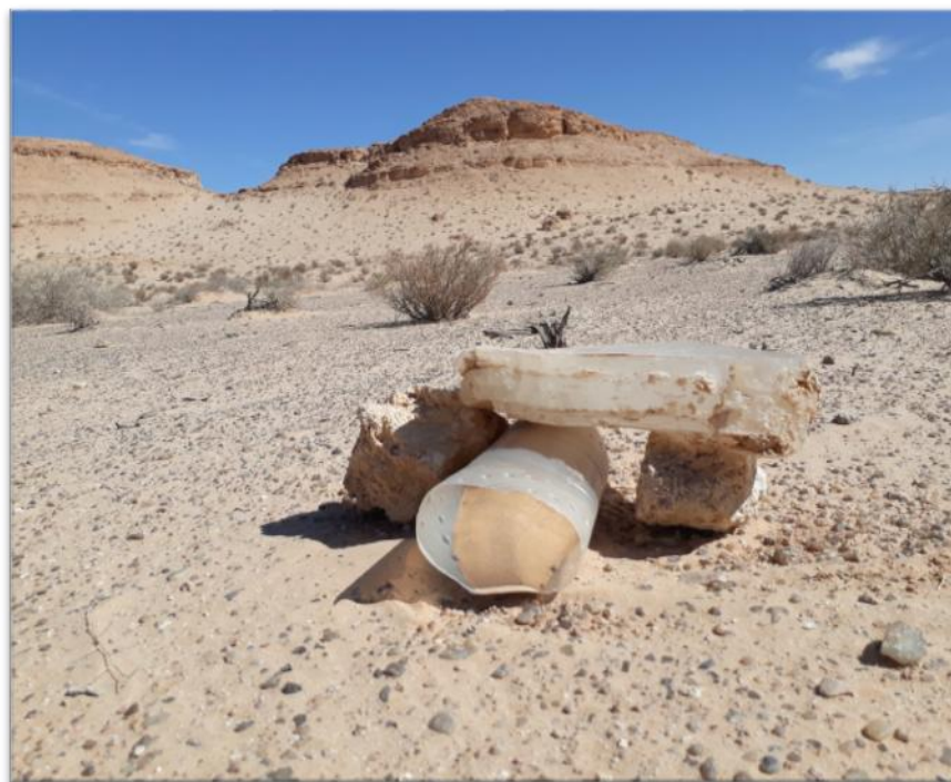
Photo 1. Piège à sable pour d'échantillonnage des particules du sol transportés par le vent (poussières).
