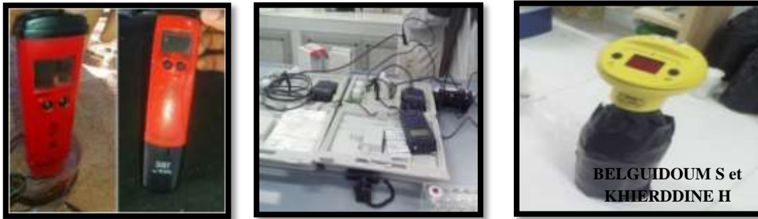
Photo4. Détermination de la conductivité électrique, de la salinité, de la température, pH et d'Oxygène dissous
