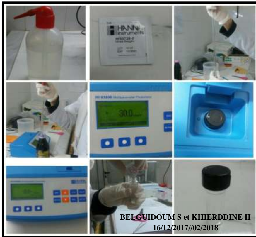
Photo 5. Détermination de chlore totale, nitrite et nitrate
