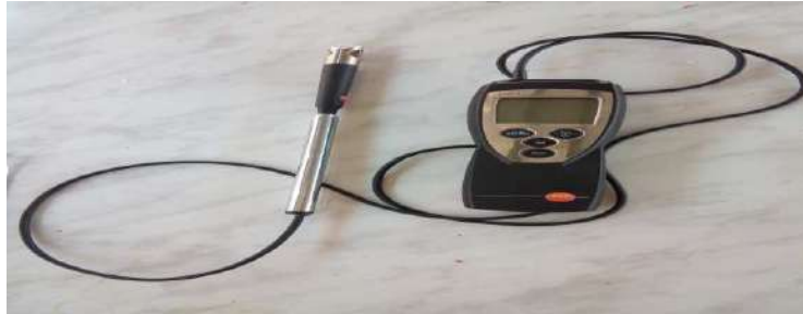
Figure II.7 : Appareil pour mesurer la vitesse de l'air asséchant.
