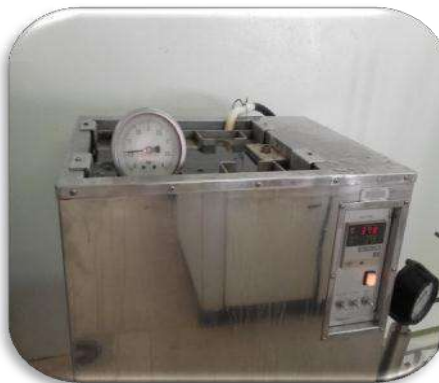
Figure III.02. Mesure de la TVR
