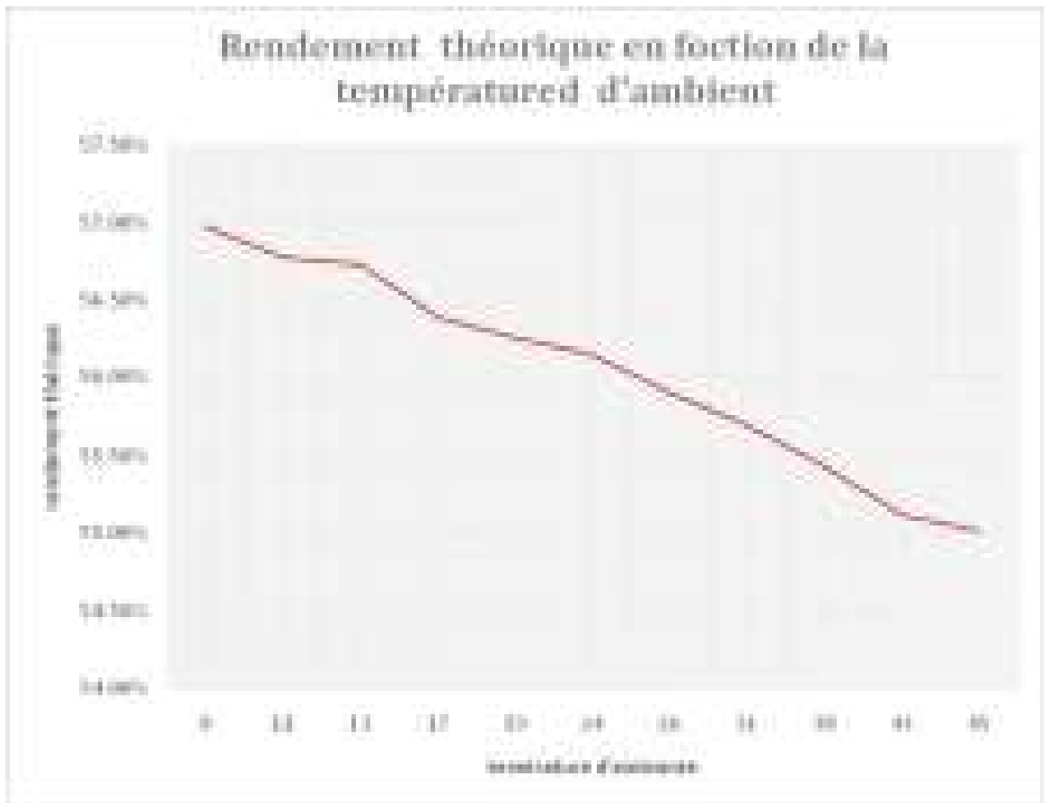
Figure (3-5) : Diagramme représentant la variation du rendement théorique en fonction de la température ambiante
