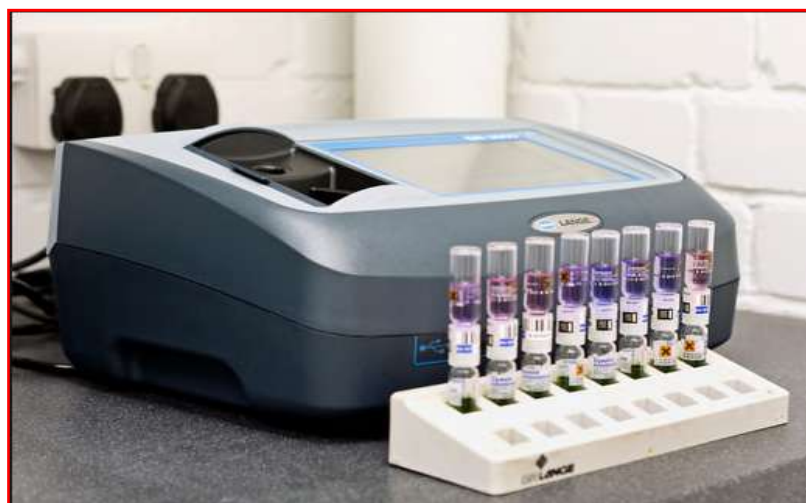
Figure 50 : Spectrophotomètre HACH DR 3900
