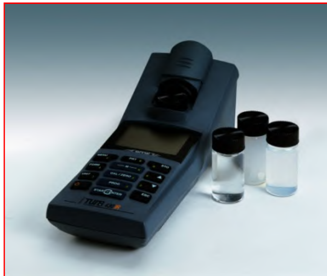
Figure 49 : Turbidimétrie optique WTW Turbo 430 IR
