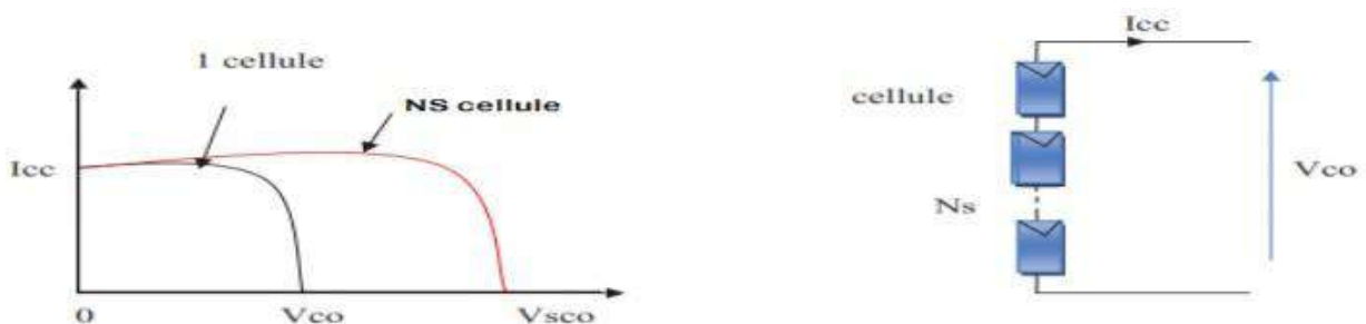
Figure I.4 Caractéristique résultante d'un groupement en série de n_s cellules identiques [2]
