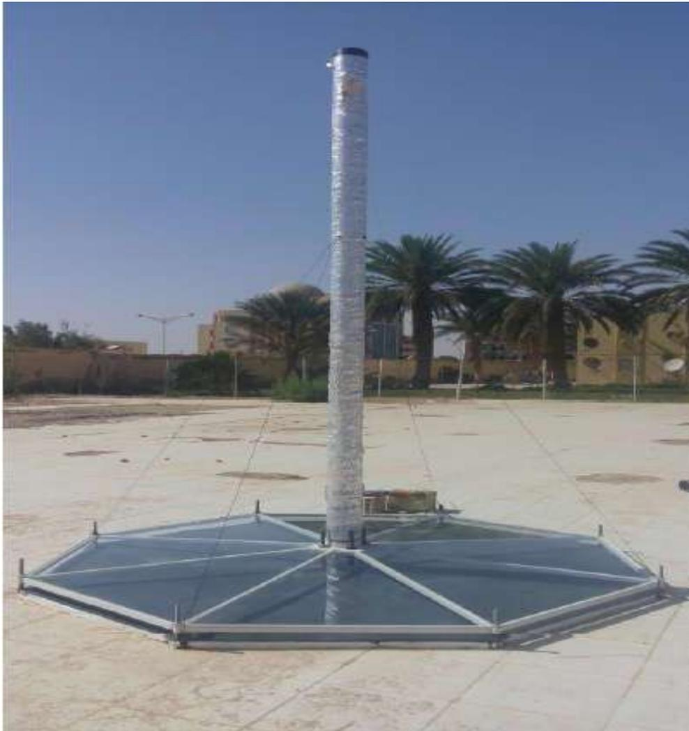
**Fig. III.1:** Image de prototype optimale de cheminée solaire
