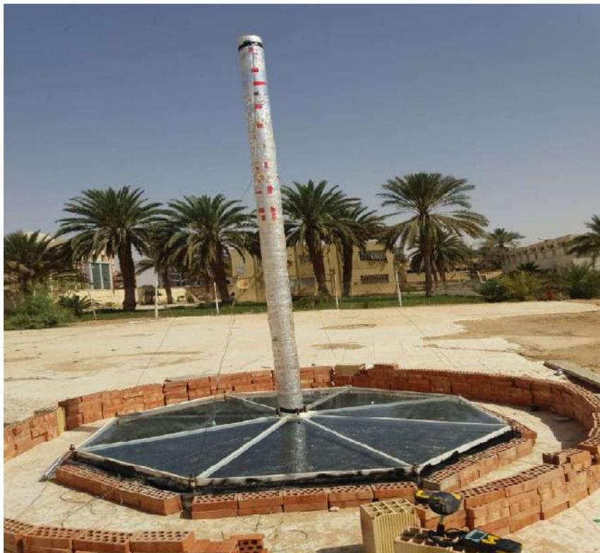
**Fig. III.9:** Prototype de cheminée solaire avec stockage
