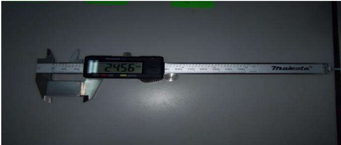
Figure (II-9): mesure les démontions par le pied canalaire «maiesta»
