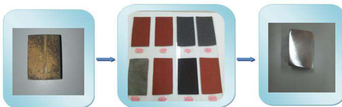
Figure II.7: polissage (préparation de surface).
