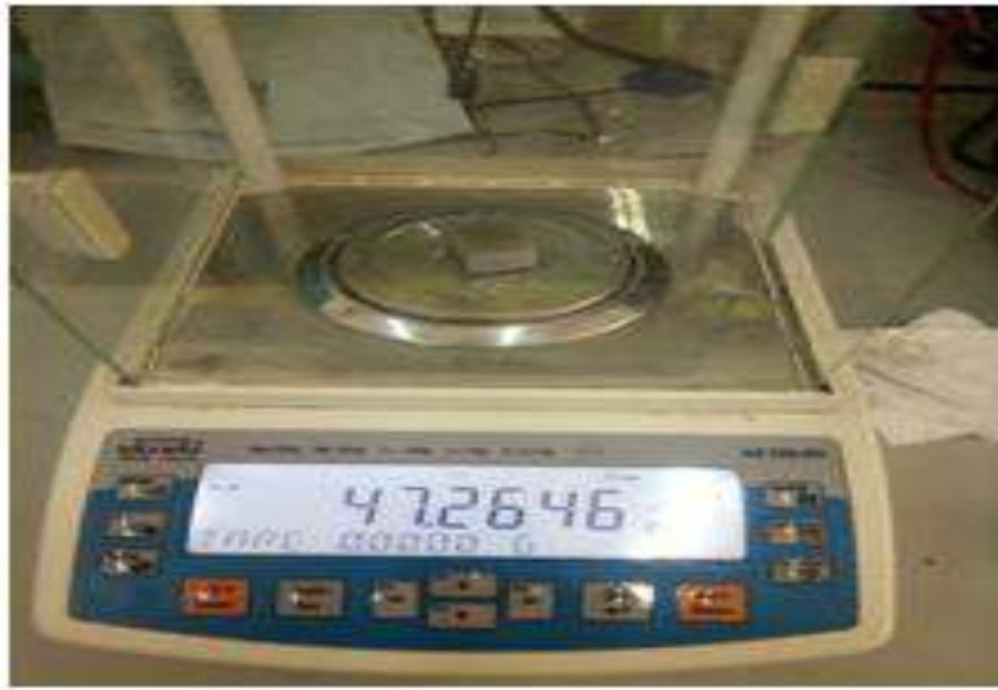
Figure (II-10) : la balance de marque « RADWAG » de type (AS 220 R2).
