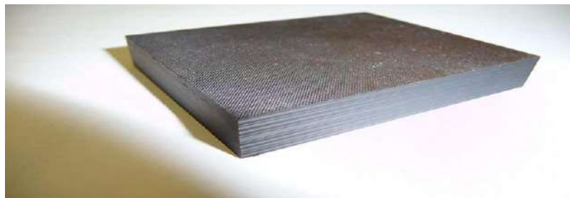
Figure (1.1) Un petit échantillon d'un stratifié Carbone/Epoxyde (domaine de l'aérospatiale)[11]
