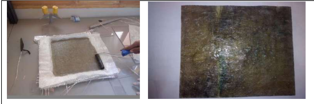
Figure(3.3) :les plaques orthotropes des couche mat et tissu et toile avant et après 24 h.
