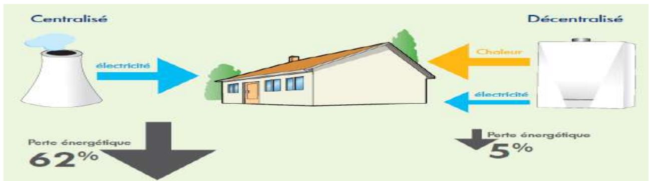
Figure II.2. Comparaison entre centrale électricité et micro cogénération [19]
