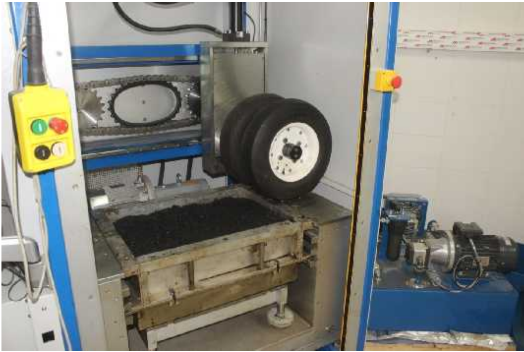
Photo IV.5. Compactage d'une plaque de module et fatigue.
