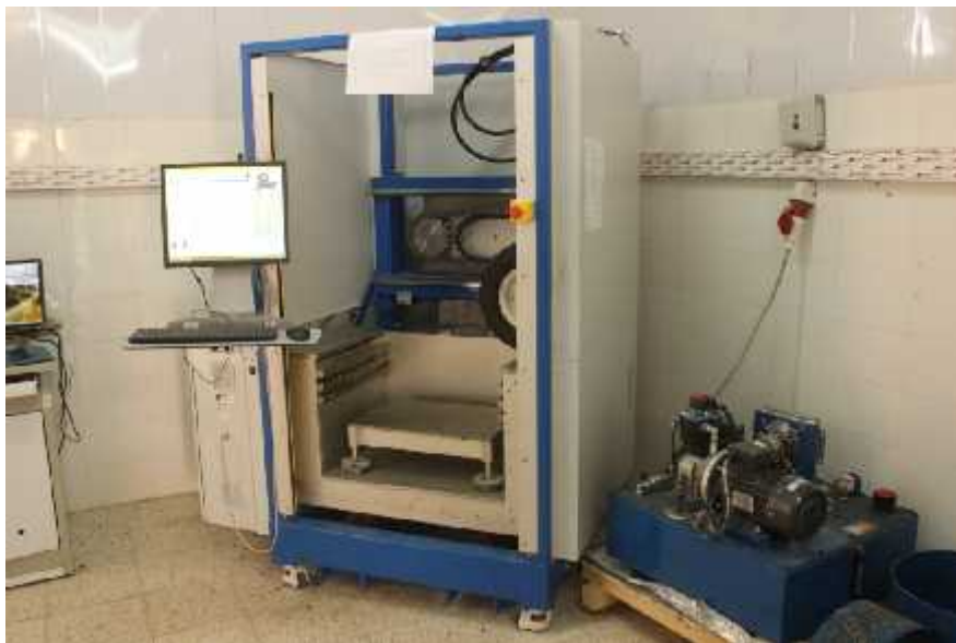
Photo IV.3. Table de compactage (compacteur à roue).
