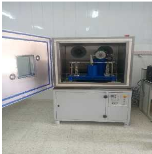
Photo II.12. Machine de flexion deux points.
