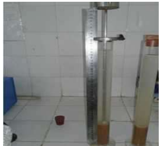
Figure. III.3 : Principe d'essai d'équivalent de sable.
