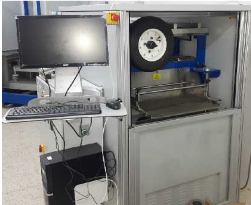
Photo II.8. Machine de l'essai d'orniérage.
