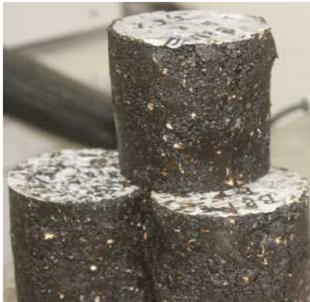
Photo II.7. Compression des éprouvettes
