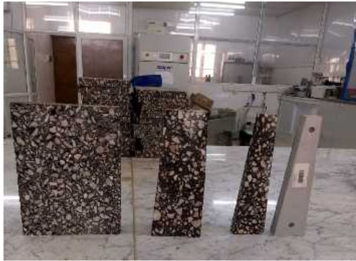
Photo IV.7. Etapes de former une éprouvette trapézoïdale à partir une sous plaque de 25 mm d'épaisseur.
