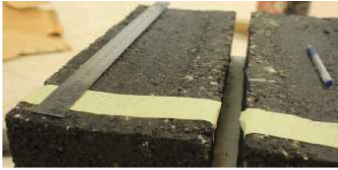
Photo II.11. Échantillon après procédure de l'essai d'orniérage.
