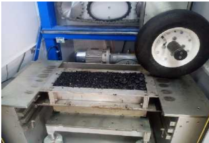
Photo II.9. Préparation de plaque sur le table de compactage.
