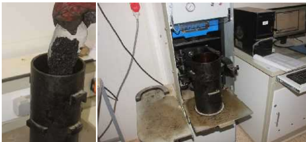
Photo IV.1. Essai de presse cisaillement giratoire.
