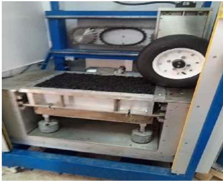
Photo II.14. Compactage des plaques.
