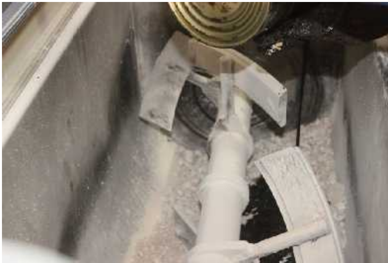
Photo II.2. Malaxage des granulats avec un bitume pur
