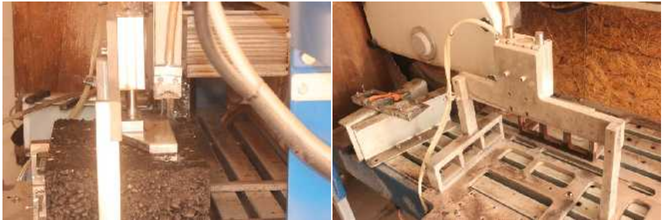
Photo IV.6. Coupure de plaque au but de préparer les trapèzes par une scie mécanique.
