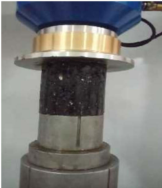
Photo II.7. Compression des éprouvettes
