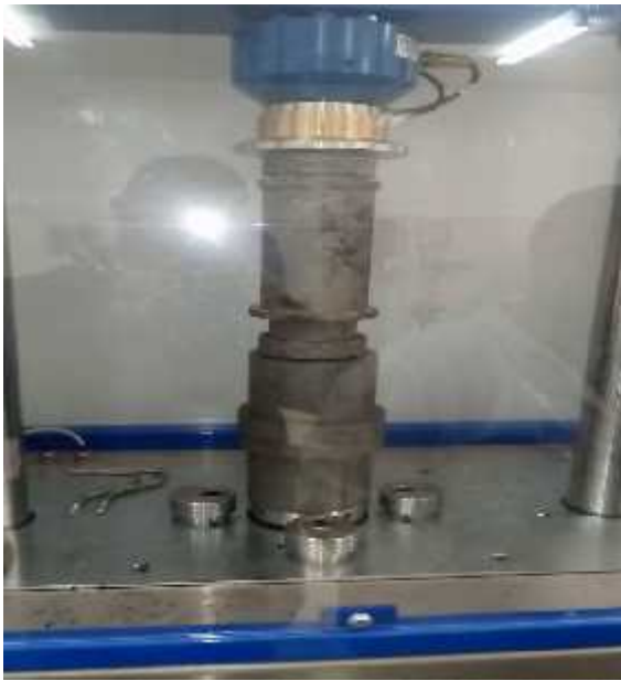
Photo II.5. Compactage des éprouvettes
