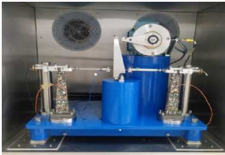
Photo II.15. Essai de flexion 2 points sur éprouvette trapézoïdale.
