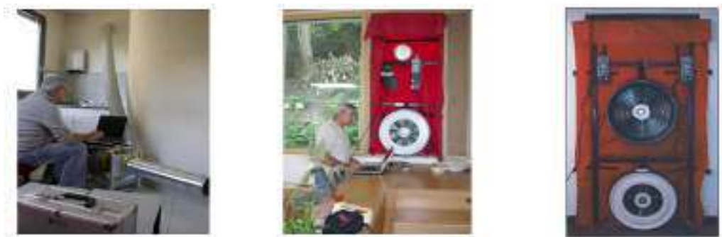
Figure II. 7: Mesure de la perméabilité d'air dans une porte [16]
