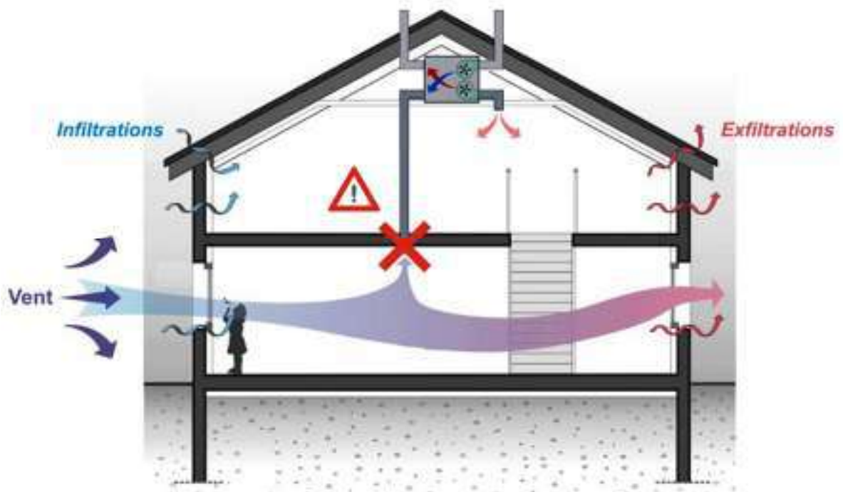
Figure II. 3: Courant d'air traversant [1]
