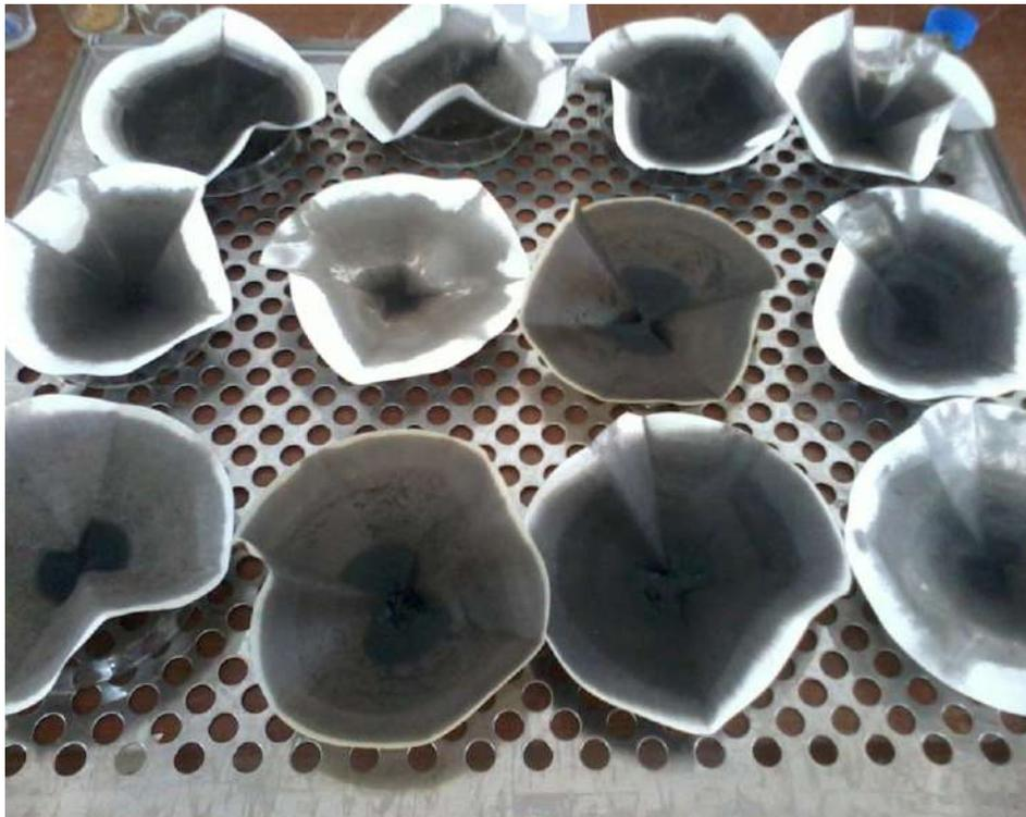
**Photo 02:** Filtration pour la détermination de MES.
