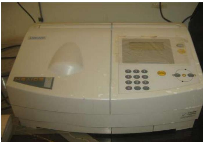
**Photo 7:**Le spectrophotomètre UV-visible.
