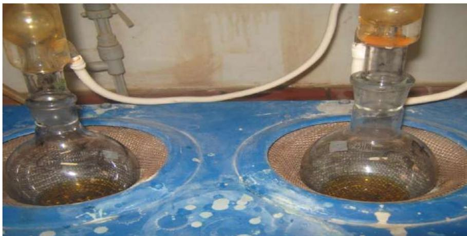
**Photo 04:** Montage à reflux pour la détermination de la DCO.
