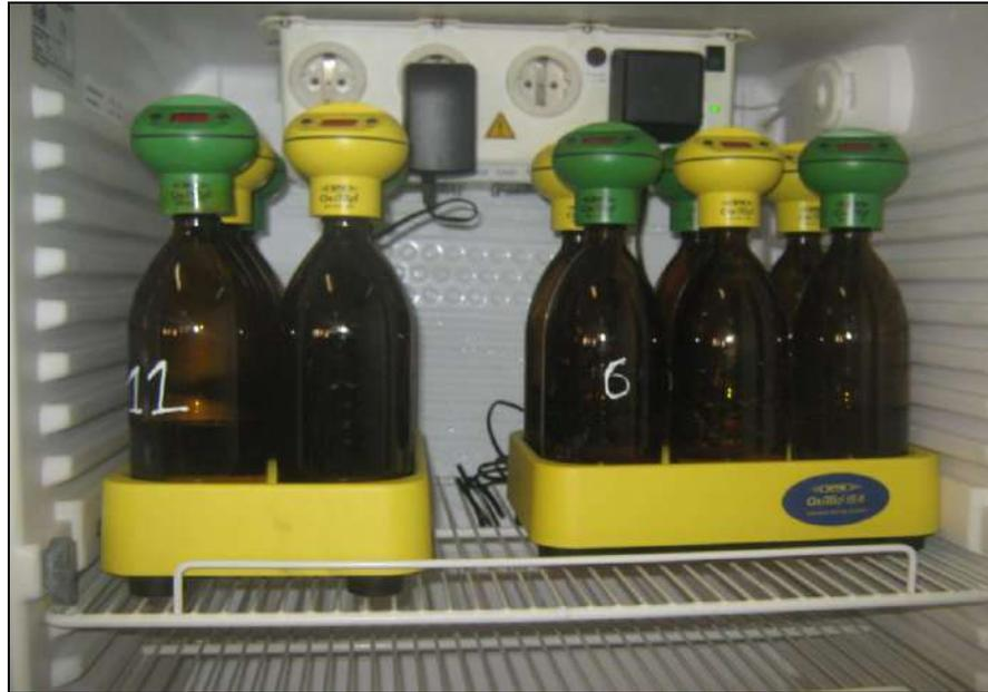
**Photo 03:** La DO mètre pour la détermination de la DO.
