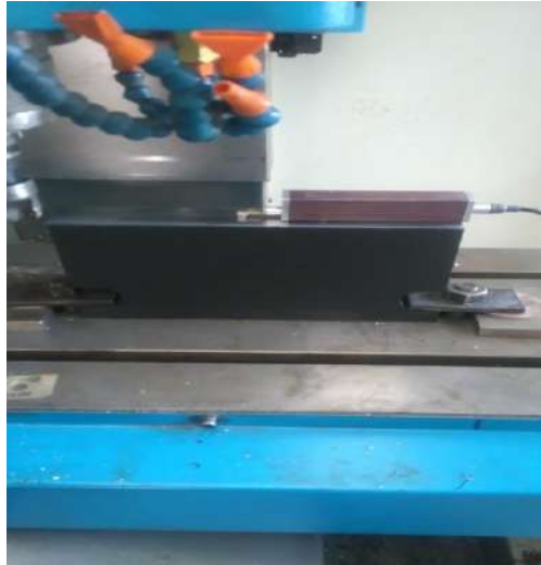
Figure I.22: Image montrant testeur de rugosité[29].
