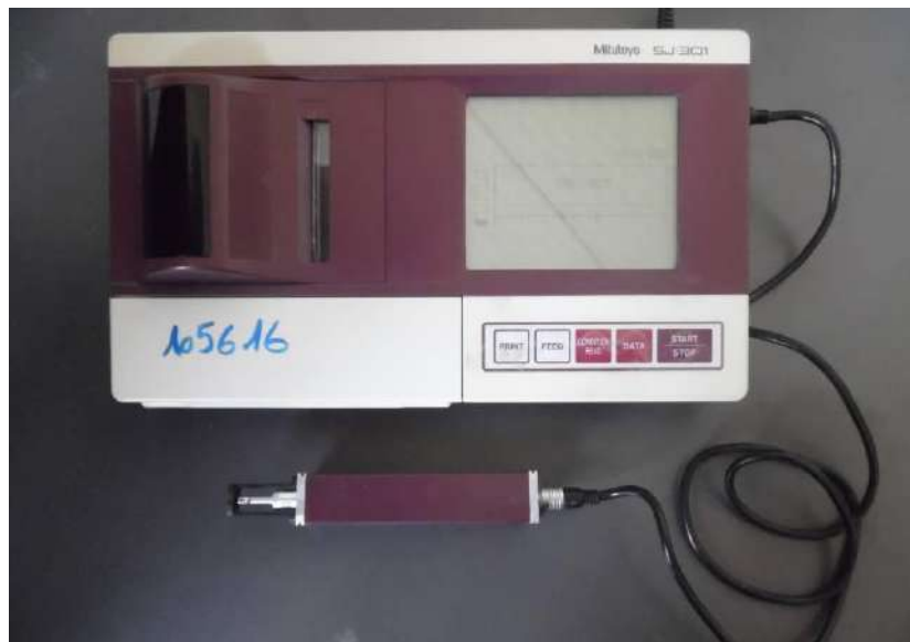
Figure I.21: Rugosimètre utilisé de type Mitutoyo SJ 201P [29].
