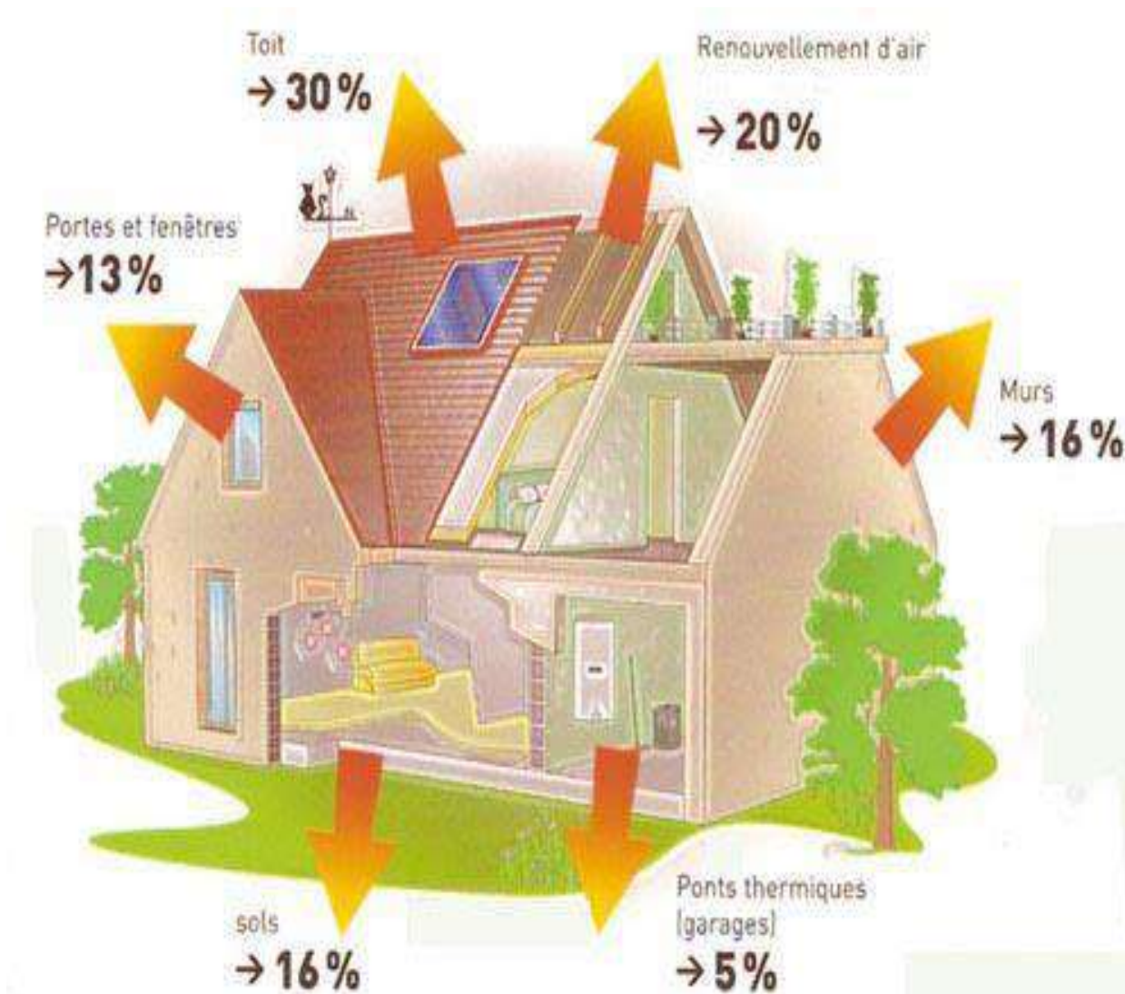
Figure I.6 : Le principe de l'isolation thermique.
