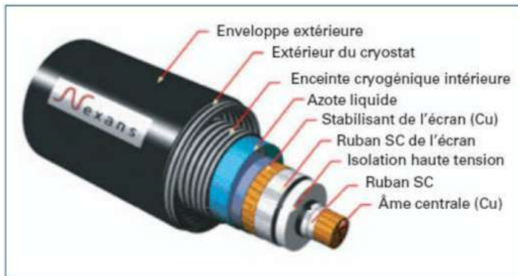
Fig. I.6 : Coupe du câble supraconducteur de projet Long Island (USA) (photo Nexans)[26].
