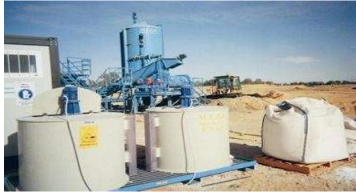
شكل 2-6 : صورة خزان محلول السيليكات
