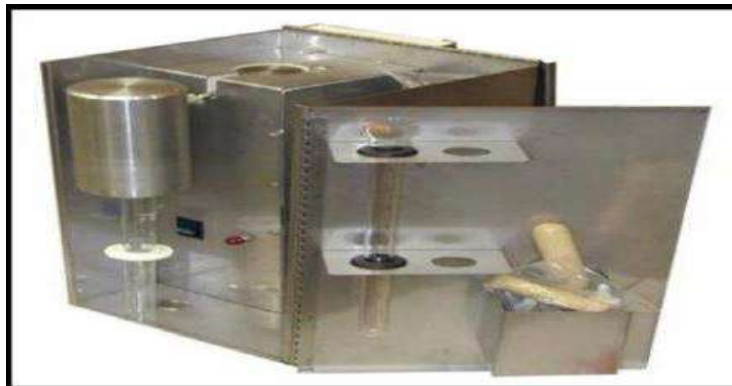
شكل 2- 11 :صورة جهاز التقطير الخاص بالطين Distillateur FANN
