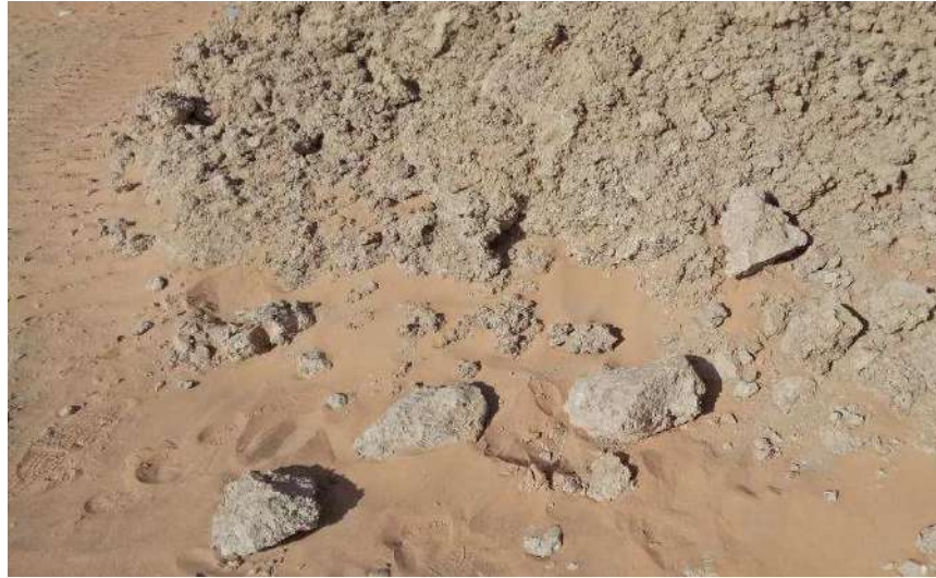
شكل 2-3 : صورة حجر اصطناعي ناتج من عملية تصليد نفايات طين الحفر
