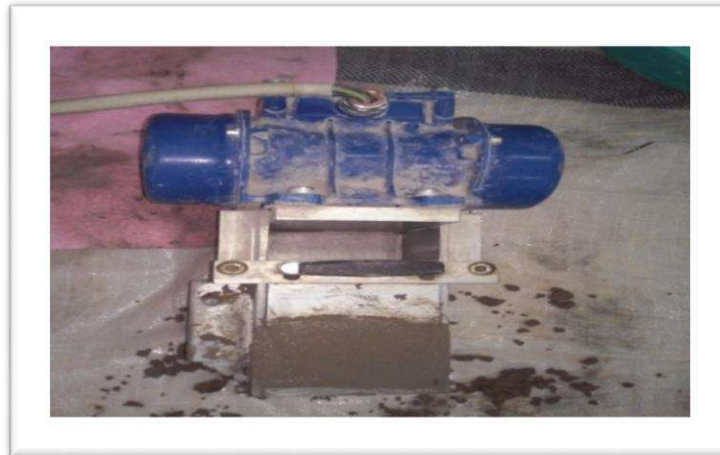
Photo II.7: Essai de Maniabilimètre
