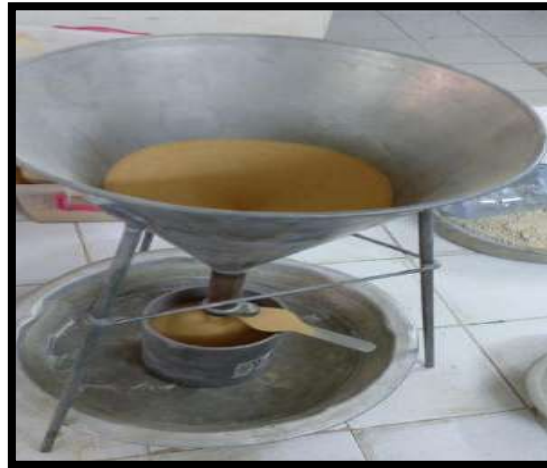
Photo II.4 : Essai de la masse volumique apparente
