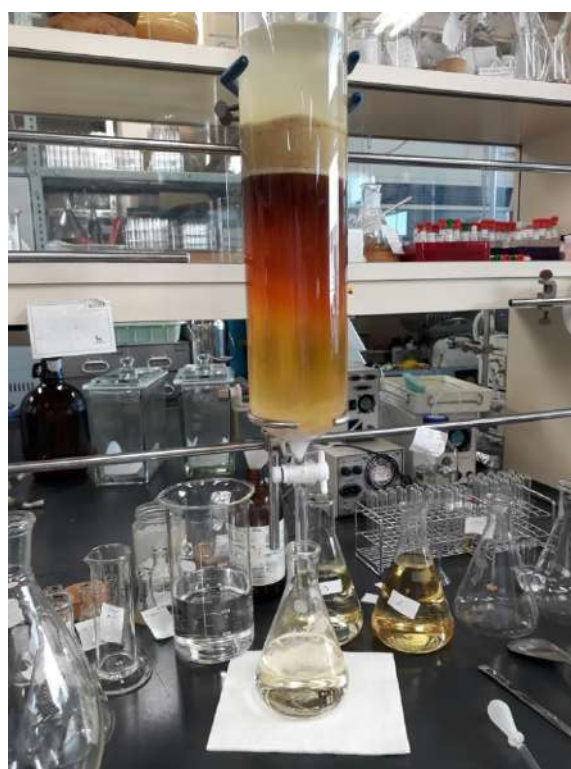
Figure V-2 : Colonne chromatographique pour séparation de la phase Butanolique
