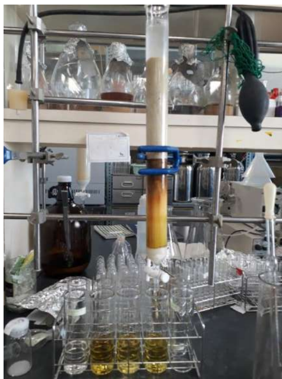
Figure V-1: Colonne chromatographique pour séparation de la phase chloroforme+acétate d'éthyle
