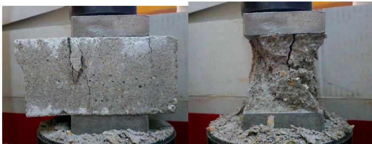
Photo II-6 rupture des éprouvettes soumis dans la solution sulfate de magnésium
