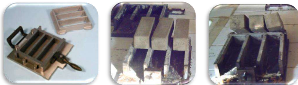
Figure III-3 Moules pour éprouvettes de mortier prismatique 4x4x16
