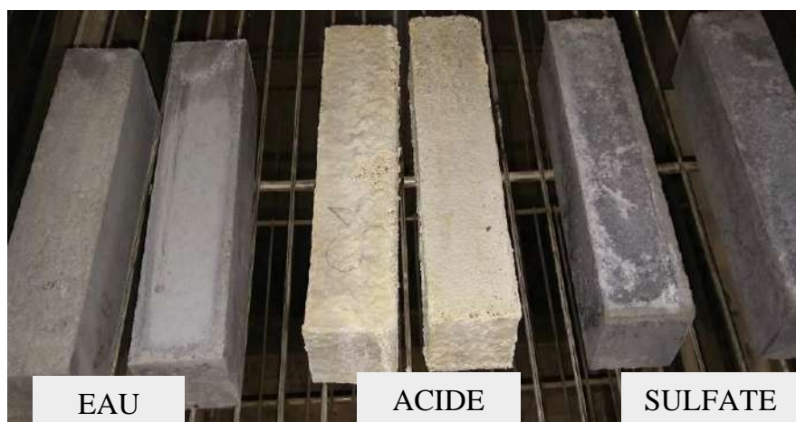
Photo IV-3 État de surface des éprouvettes de ciment pétrolier
