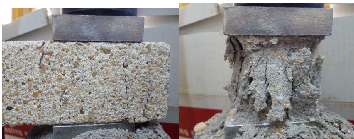
Photo II-7 rupture des éprouvettes soumis dans la solution acide sulfurique
