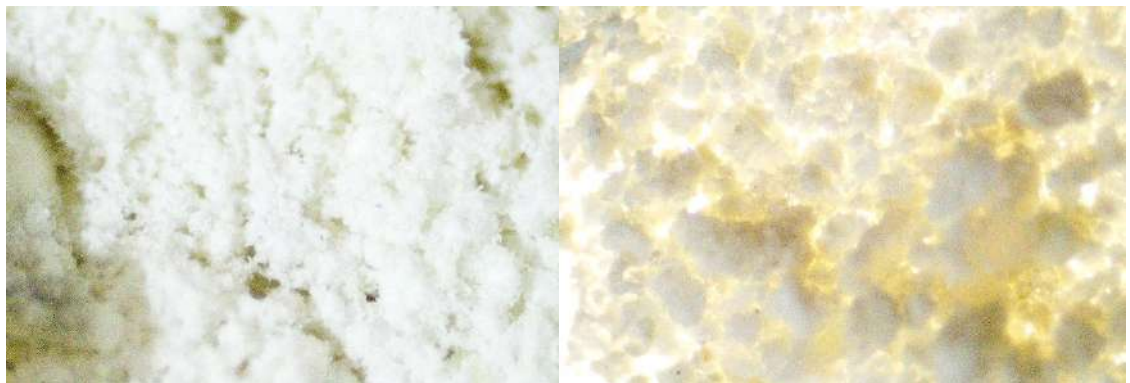
Photo IV-8 couche formée sur les éprouvettes soumise dans l'acide sulfurique
