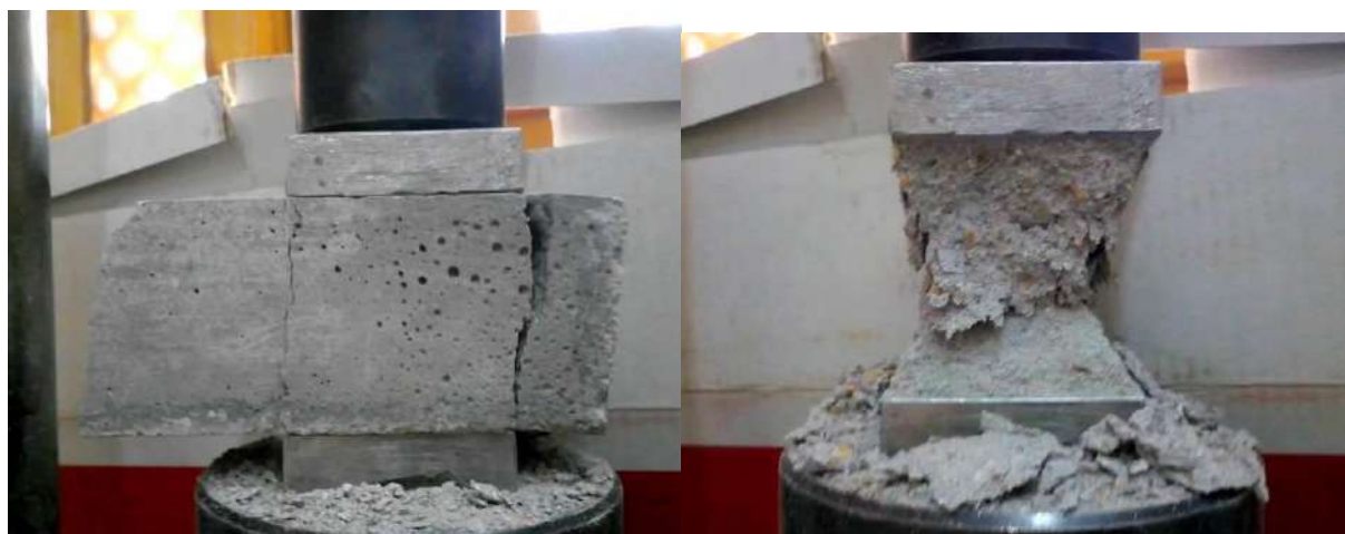
Photo II-5 rupture des éprouvettes soumis dans la solution témoin (eau douce)
