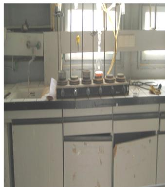
**Photo (17) :** Fibertec manuelle 1<sup>ère</sup> étape (l'attaque)
