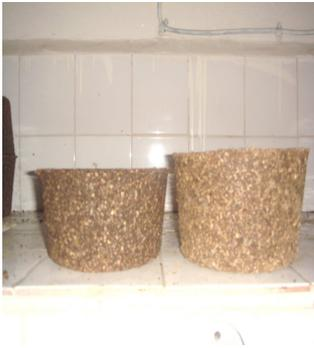
**Photo (10) :** Démoulage et séchage des blocs
