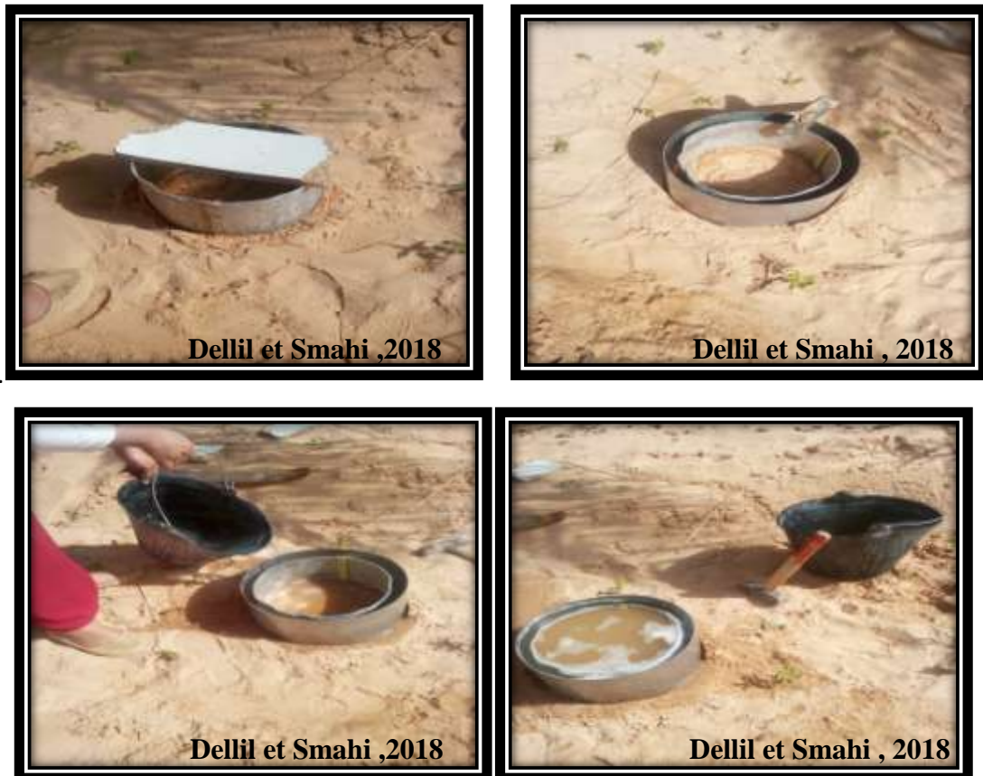
Photo N° :04 : Etapes de méthodes Taux d'infiltration
