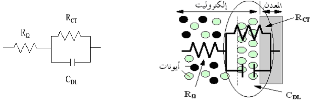
الشكل (II-23): نموذج يبين حالة معدن متآكل [2]
