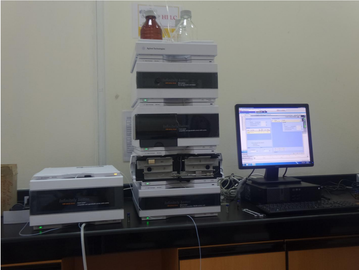
الشكل-III-2-جهاز HPLC متصل ب UV
