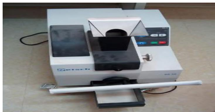
الشكل(III-5) : جهاز الطحن الميكانيك المستخدم لسحق العينة
