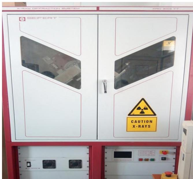
الشكل (3-II) : جهاز حيود الاشعة السينية
