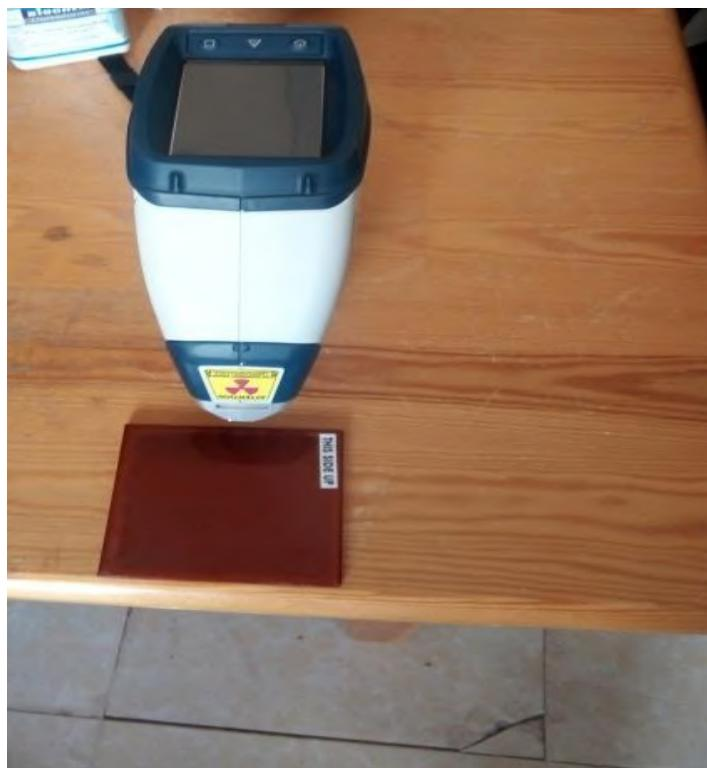
الشكل (II\_4): جهاز الفلورة بالأشعة السينية
