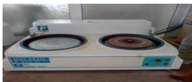
الشكل(III-4):جهاز الصقل الميكانيك المستخدم لتنظيف العينة
