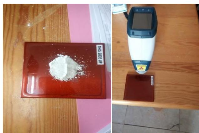
الشكل(III\_8) : جهاز الفلورة بواسطة الاشعة السينية
