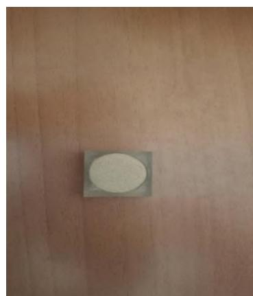
الشكل(III\_7) : العينة المحضره للتحليل بجهاز حبود الاشعة السينية
