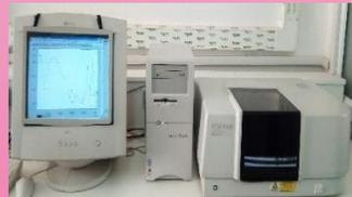
جهاز الامتصاص تحت الحمراء SHIMADZU FTIR - 8300
