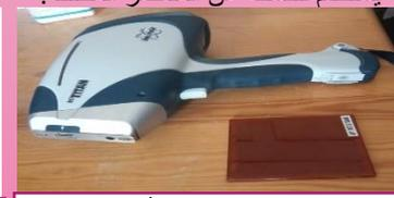
جهاز التحليل بفلورة الأشعة السينية TITAN BRUKER
