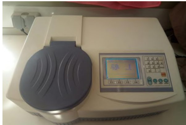
الشكل (IV-3): جهاز مطيافية المرئي وفوق البنفسجي
