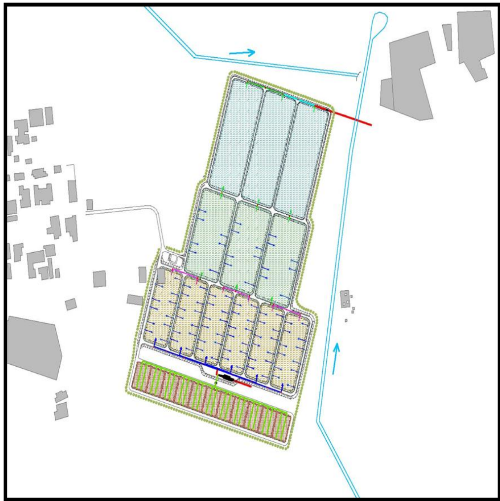
Figure N° 10: Plan général de la station d'épuration.
