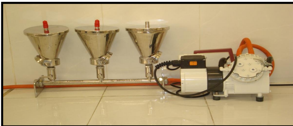
Photo N° 11: Unité de filtration avec pompe à vide.
