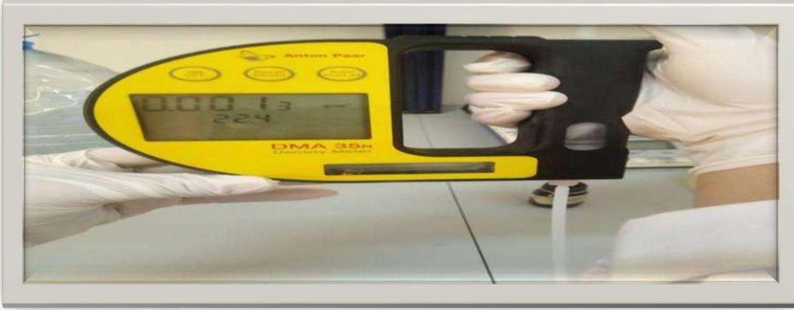
الصورة (9-III): جهاز قياس الكثافة النسبية (Densimètre)
