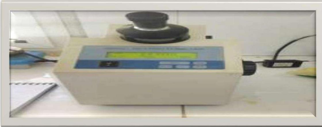
الصورة (10-III): جهاز قياس قرينة الانكسار (Réfractomètre)
