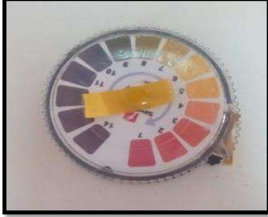
الصورة (III-3): pH زيت الجزر. الصورة (III-4): pH زيت الزيتون.
