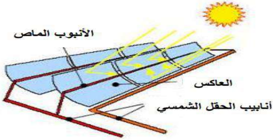
الشكل (2-3): تقنية القطع الناقص [17]
