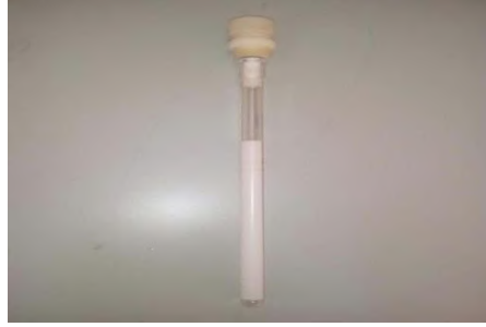
صورة (14): جهاز قياس اللزوجة من نوع GV-2200/Flling Ball
