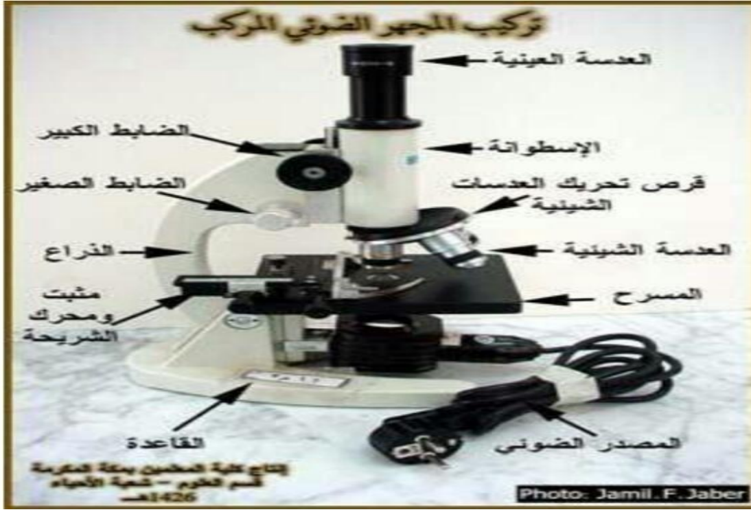
الشكل 1. 7: رسم تخطيطي لتركيب المجهر الضوئي المركب.
