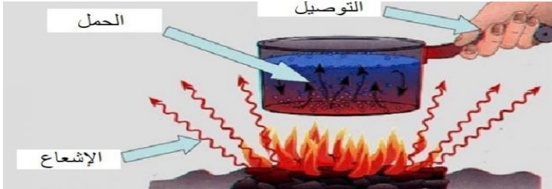
الشكل 1.2: صورة توضح طرق انتقال الحرارة
