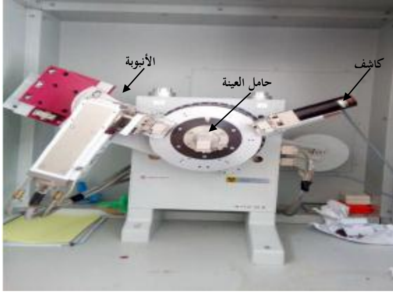
الشكل (3.III): المكونات الأساسية لجهاز انعراج الأشعة السينية XRD
