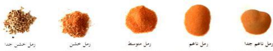
الشكل (4.I): تصنيف الحبيبات الرمل على حساب الغرابيل وفقا ل USDA
