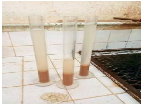
الشكل (6.II): توضح صورة تجريبية المتحصل عليها لمكافئ الرملي
