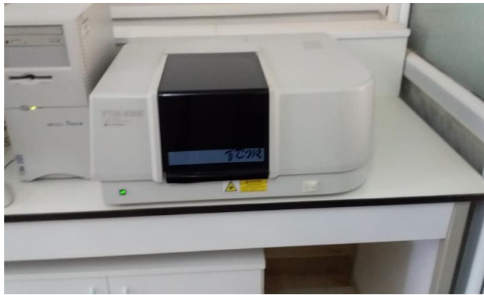
الشكل (II-20): جهاز مطياف الأشعة تحت الحمراء المستعمل في الدراسة
