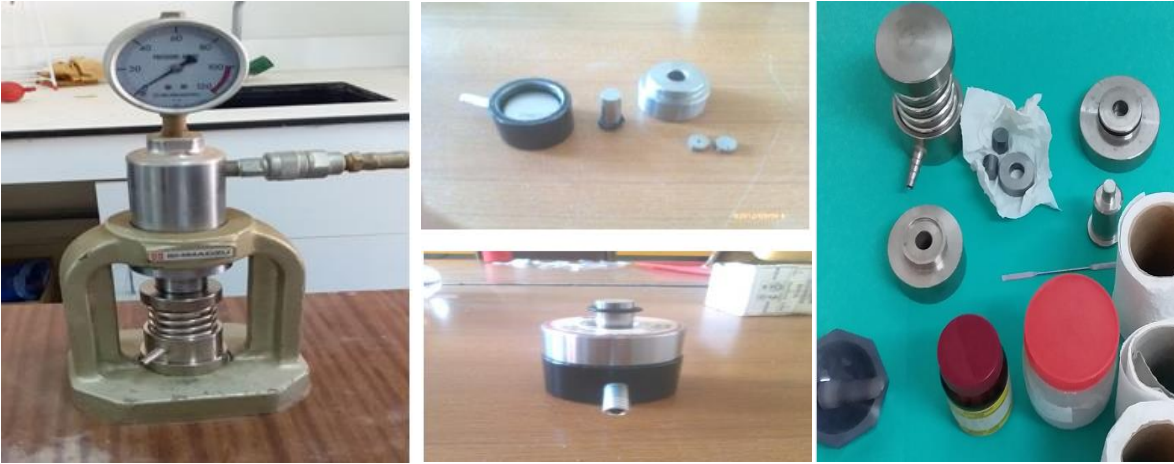
الشكل (II-21): الأدوات المستخدمة في تحضير العينات لعرضها على جهاز FTIR
