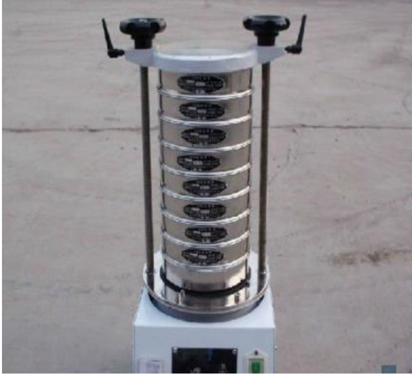
الشكل (I-3): مجموعة المناخل المستخدمة في تحديد البعد الحبي للرمل
