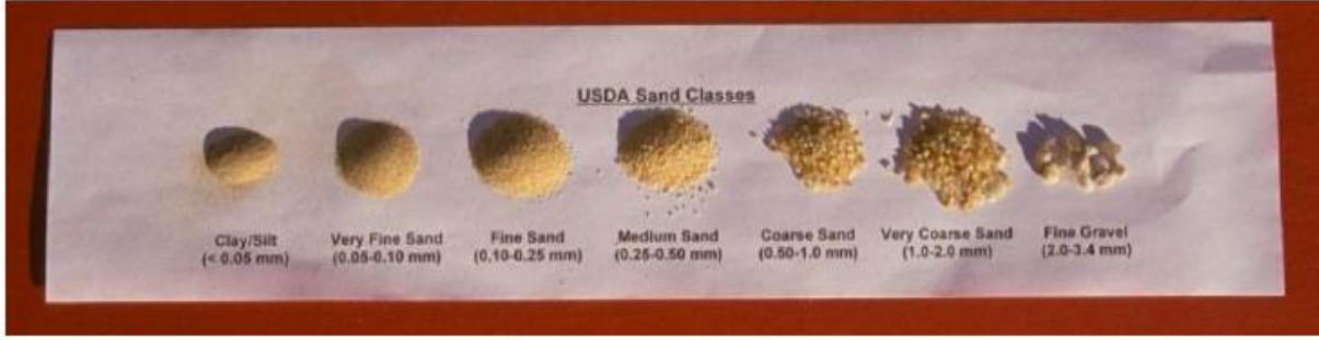
الشكل (I-2): تصنيف حبيبات الرمل وفقاً لأبعادها [19]
