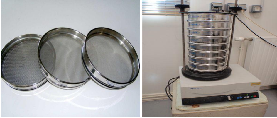
الشكل (II-4): الهزاز الميكانيكي و الغرايل القياسية المستعملة في التصنيف الحبيبي
